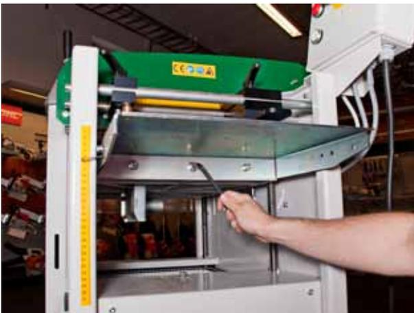
1. Снимите стол подачи, установленный на станке. Сохраните винты и гайки. Установите нижнюю фиксирующую плиту на станину с помощью ранее сохраненных винтов и гаек. Завинтите установочную угловую плиту 2 я винтами M8x20 (вкл. гайки и прокладки).
