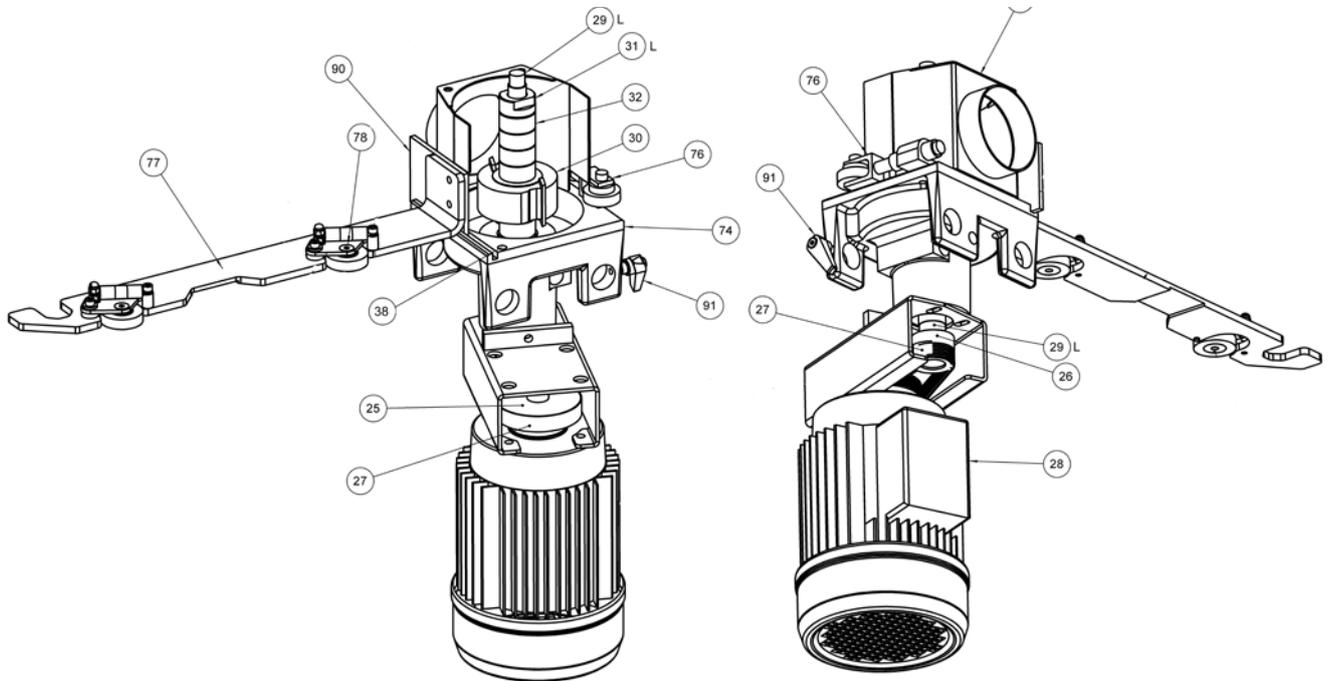
НИЖНЯЯ ФРЕЗА, НЕПОДВИЖНАЯ ФРЕЗА, ПЕРЕДАЧА ПОДВИЖНОЙ ФРЕЗЫ,
