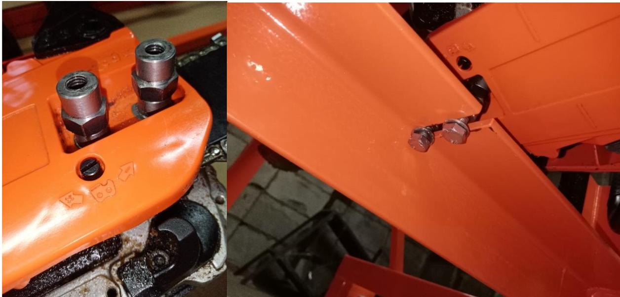
Установите приспособление для управления дросселем газа на рукоятку бензопилы, как показано на рисунке ниже, предварительно установив трос газа.
