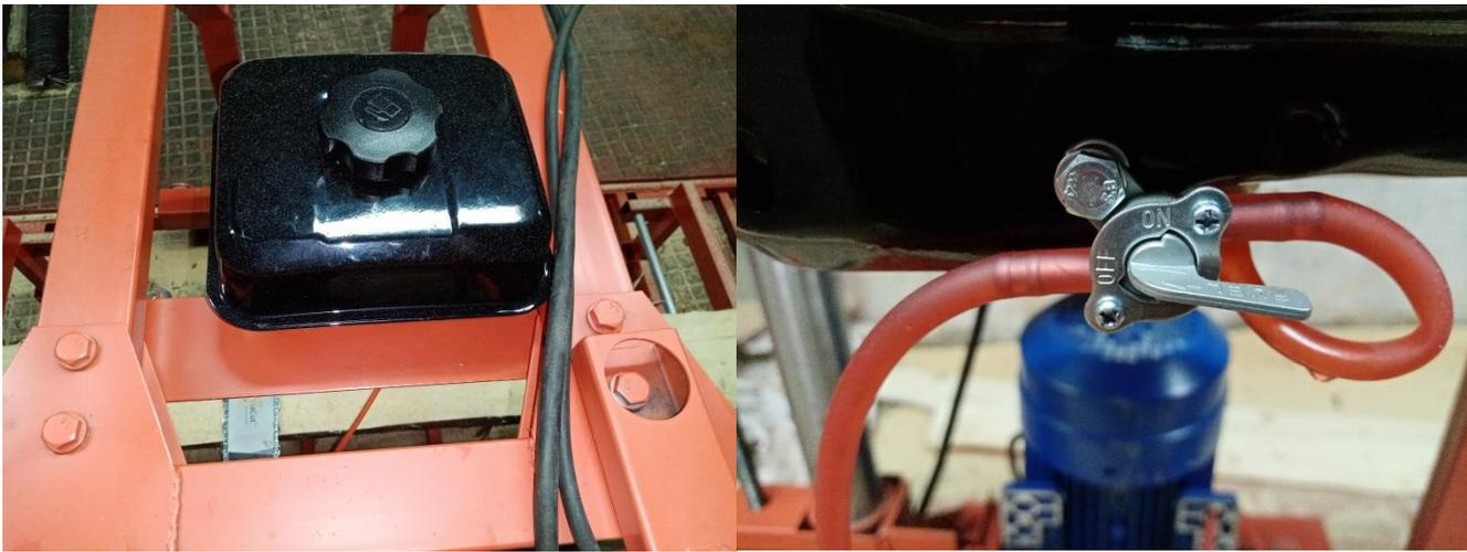
Соедините шлангом кран бака и штуцер на крышке пыльной гарнитуры.
