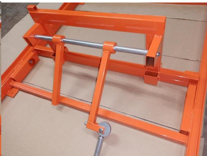
При необходимости собранную конструкцию можно закрепить саморезами к заранее подготовленному ровному основанию через монтажные отверстия.
