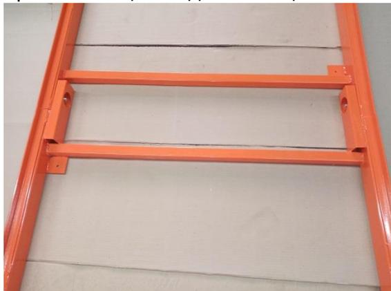
На поперечины направляющего пути установите опоры с зажимами. Опоры устанавливаются в зависимости от длины распиливаемой заготовки и при необходимости могут быть переставлены на другие секции.
