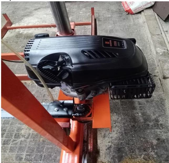
Установите распорную втулку на вал двигателя, затем установите ведущий шкив (шкив большего диаметра) и закрепите болтом.
