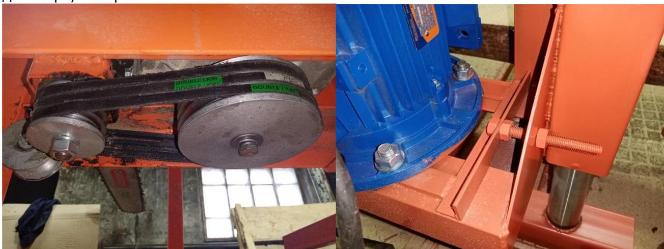
Установите клиновые ремни на шкивы двигателя и ведомого вала. При помощи натяжителя отрегулируйте натяжение ремней таким образом, чтобы исключить их пробуксовывание во время работы. Затяните болты крепления двигателя.
