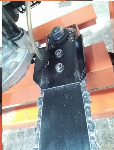
**Установка системы смазки**
