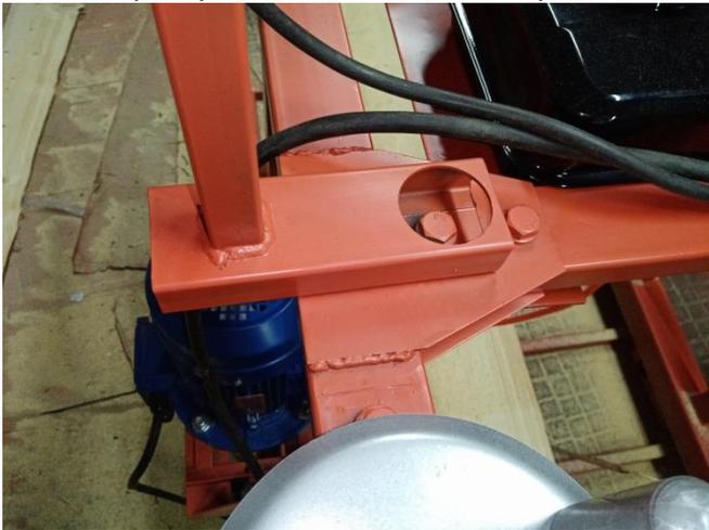
Прикрепите вспомогательную стойку раскладки кабеля к пластине кронштейна. Опустите трос в желоб стойки. Прикрепите первую подвеску кабеля к вспомогательной стойке, а последнюю подвеску к дальней опоре пластиковыми хомутами.
